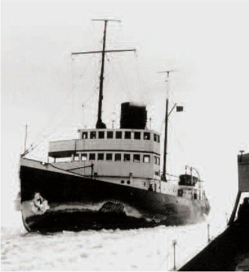
Abb. 18: Die notreparierte Stb.-Brücke nach dem Ramming mit der DESSAU am 11.1.1940.
